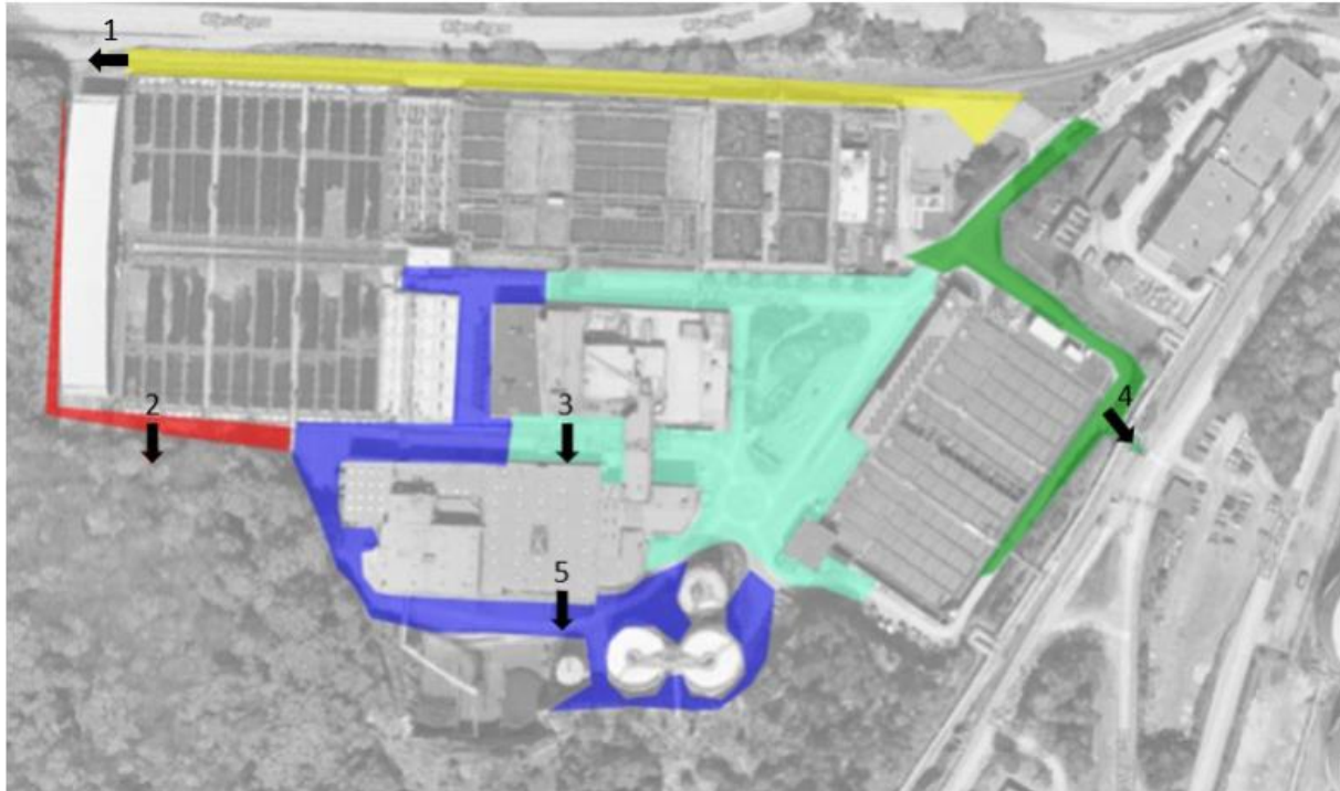
Figur 22. Dagvattensystemets fem avrinningspunkter samt avrinningsområden inom befintligt avloppsreningsverk (Gryaab) (Kretslopp och vatten, 2023).
