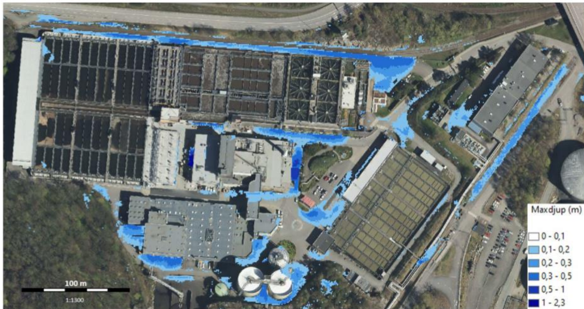
Figur 29. Maximalt djup i beräkningspunkter inom Rya 1, befintligt reningsverk, under översvämningsförlopp (Norconsult, 2021).
