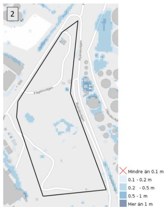
Figur 26. Beräknat vattendjup vid en översvämningssituation vid ett klimatanpassat 100-årsregn inom Rya 2a, Ryanäs (Kretslopp och vatten, 2023). Observera att dagvattenutredningen inte har uppdaterats med ny planområdesgräns.
