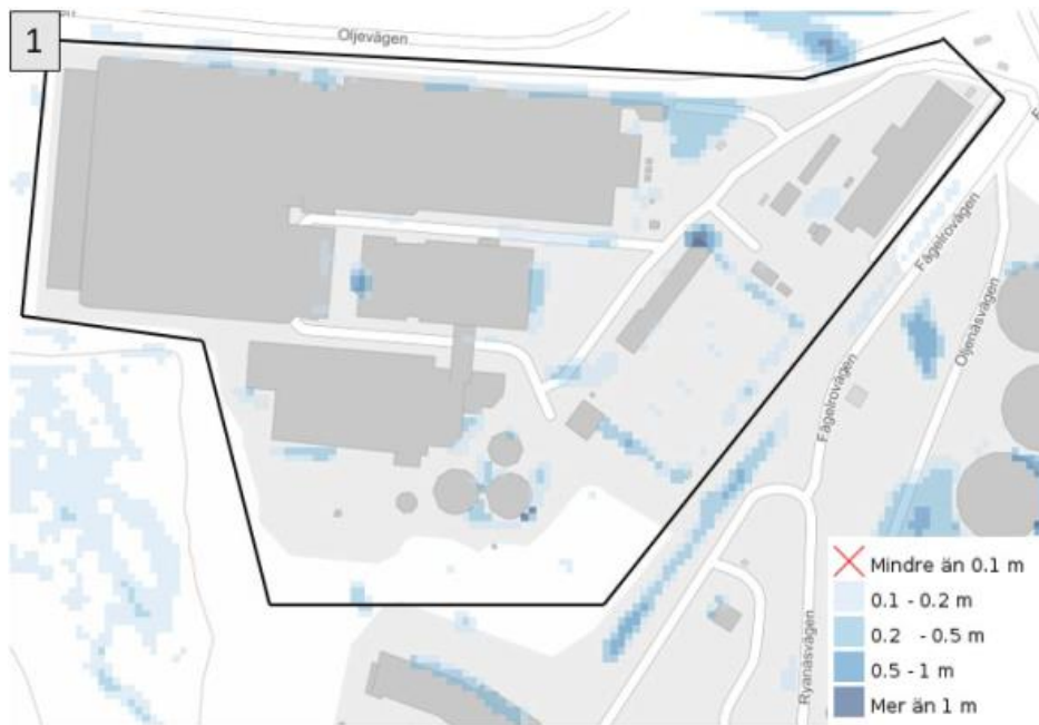
Figur 25. Beräknat vattendjup vid en översvämningssituation vid ett klimatanpassat 100årsregn. Området som redovisas är det befintliga reningsverket (Kretslopp och vatten, 2023). Områdets ungefärliga plangräns är markerad med svart linje i figuren.
