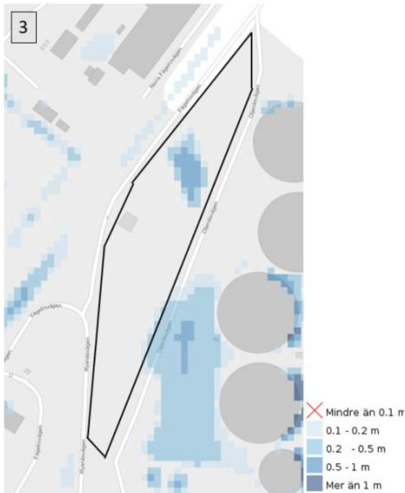
Figur 27. Beräknat vattendjup vid en översvämningssituation vid ett klimatanpassat 100årsregn på Rya 2c (Kretslopp och vatten, 2023). Områdets ungefärliga plangräns är markerad med svart linje i figuren.
